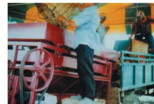
การร่อนแยกเศษเล็กๆ ของส่วนที่ไม่ย่อยสลายออก ซึ่งจะได้ลักษณะของปุ๋ยภายหลังการร่อนแล้ว
